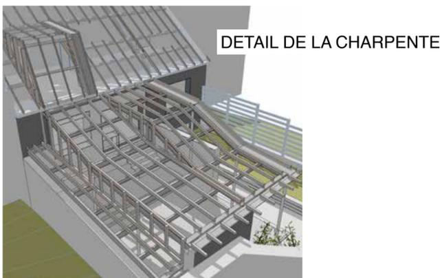
Imaginée dans un premier temps en acier, la charpente complexe de ce projet a finalement été réalisée pour des raisons de maîtrise des coûts en bois lamellé-collé Kerto®, permettant à moindre coût de travailler avec des sections proches de celles de l'acier, donc relativement fines. Ce travail d'extension s'est accompagné également d'une réorganisation partielle de la maison existante.
